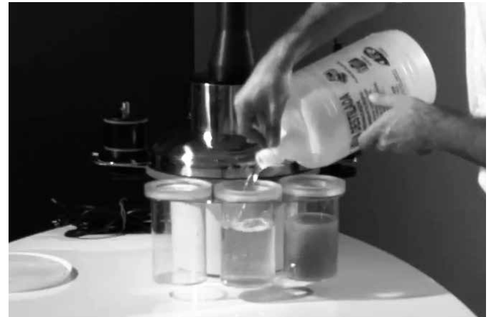
Riempimento della seconda vasca con acqua distillata Remplissage de la deuxième cuve d'eau distillée Encher a segunda cuba com água destilada
