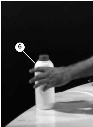
Riempimento della prima vasca con il liquido di sciacquo Remplissage de la première cuve de liquide de rinçage Encher a primeira cuba com o líquido de enxaguamento
