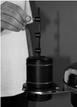
Esempio di montaggio del gancio nel telaio Exemple de montage du crochet sur le châssis Exemplo de montagem do gancho no bastidor
