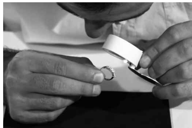
Verifica del risultato del processo di lappatura con una lente d'ingrandimento. Vérification du résultat de procédé de polissage avec une loupe. Verificação do resultado do processo de polimento com uma lupa.
