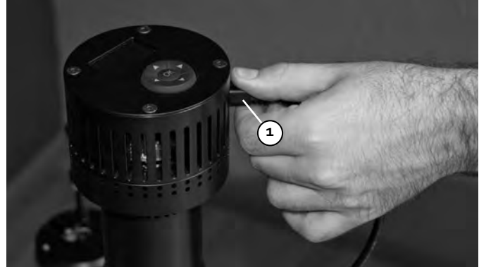
Connecting the terminal "Jack" to the machine head. Connexió del connector "Jack" al capçal de la màquina. Conexión del conector "Jack" en el cabezal de la máquina.
